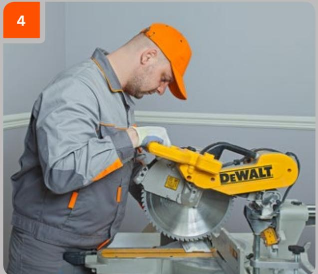
Den Winkel an der Trennsäge einstellen, einen Schnitt am Produkt vornehmen. In Räumen mit 90°-Ecken kann eine Gehrungssäge und eine Handsäge verwendet werden.
